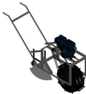
Gambar 10. Desain Mesin Penyang Jagung
